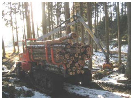
図表付 2-7 機械の改良事例 (右: ロングリーチハーベスター/左: セミクローラー型フォワーダー)
