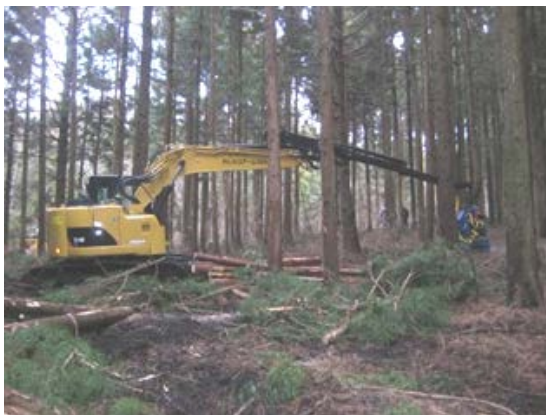
図表付 2-7 機械の改良事例 (右: ロングリーチハーベスター/左: セミクローラー型フォワーダー)
