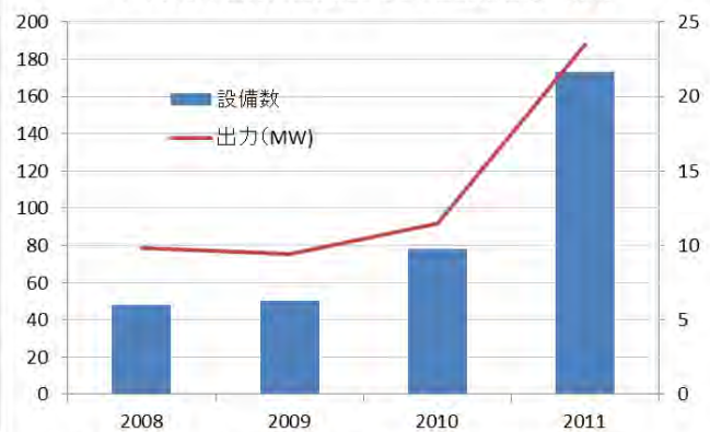
ドイツの木質ガス化発電プラントと設備容量の推移
