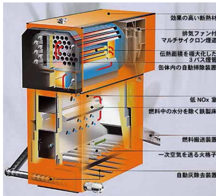
図表 7.14 高水分チップ対応型ボイラー（シュミット）
