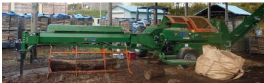
写真 5.2 トラクター動力による薪割り機械（国内）
