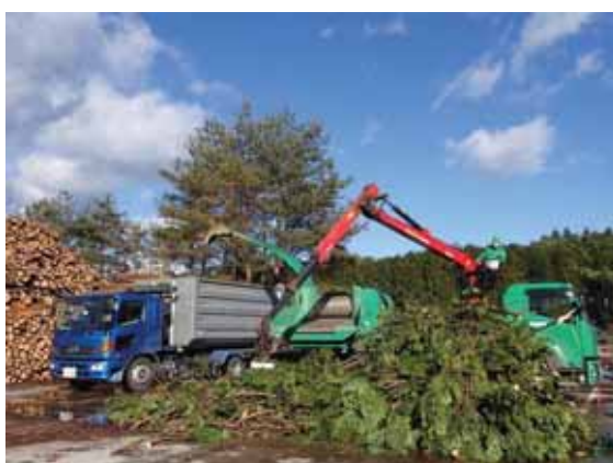
図表 7-14 工場でのチップ化状況（那須南森林組合施業地）
