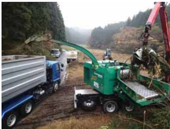
図表 7-10 山土場でのチップ化作業とチップ化できなかった根元部（那須町森林組合施業地）
