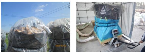
簡易送風装置での乾燥および薪焚き式温水ボイラーでの仕上げ乾燥で含水率20%以下にする。
