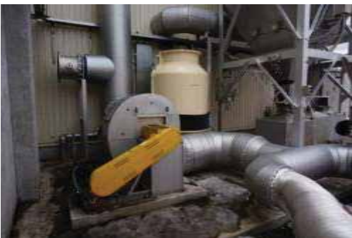
写真 2.14 排煙送粉ファンと、排煙送風状況（白煙は水蒸気）
