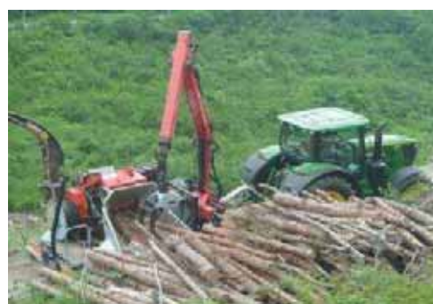
写真 2.6 モデル事業地におけるトラクターけん引式チップパー機による木くず燃料生産状況
