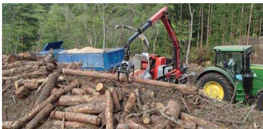
写真 2.7 トラック運搬による林地未利用材・残材集荷と木くず生産実証状況
