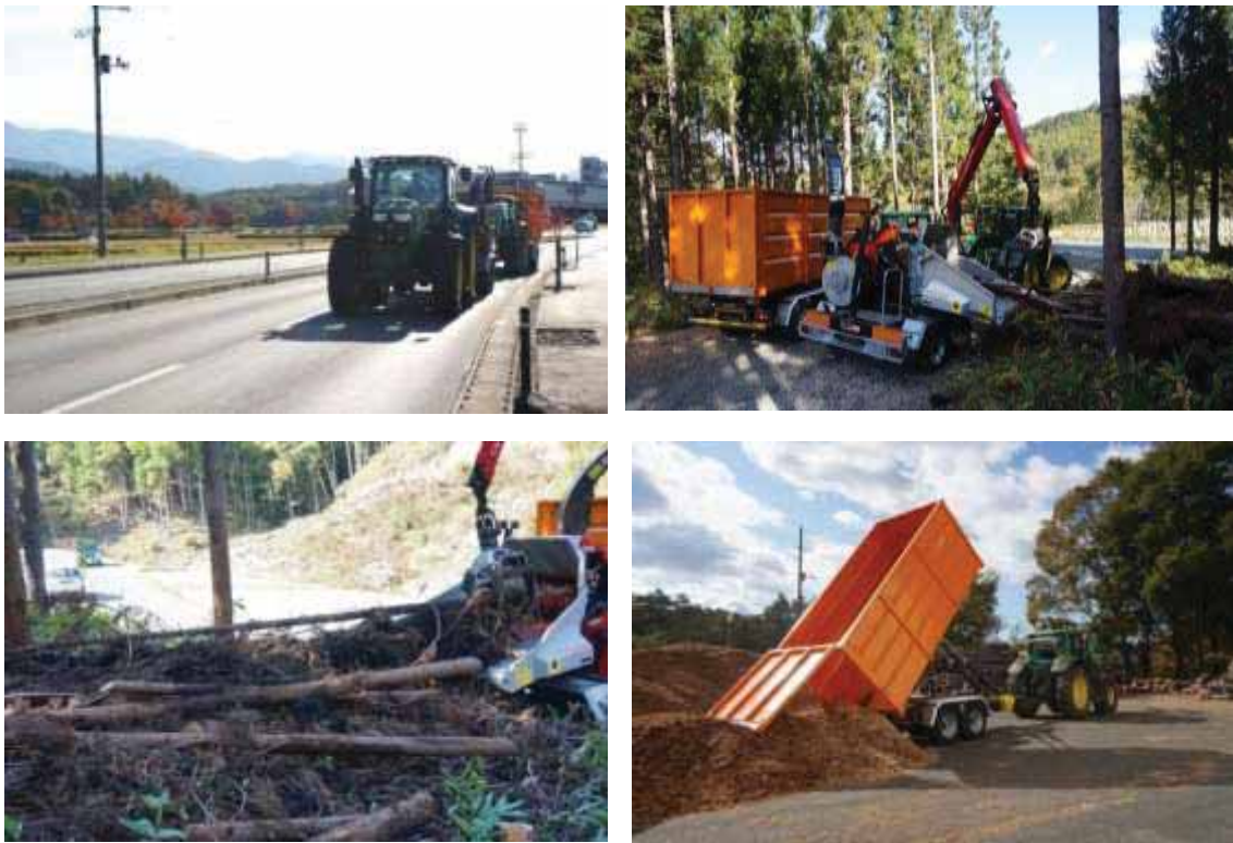
写真 2.8 けん引式コンテナによる林地未利用材・残材集荷と木くず生産実証状況
