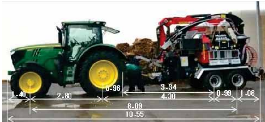
図 2.10 トラクターけん引式チップー機諸元
