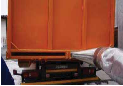
写真 2.13 排煙の送風口と送風ダクト
