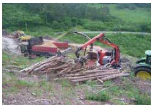
写真 2.6 モデル事業地におけるトラクターけん引式チップパー機による木くず燃料生産状況
