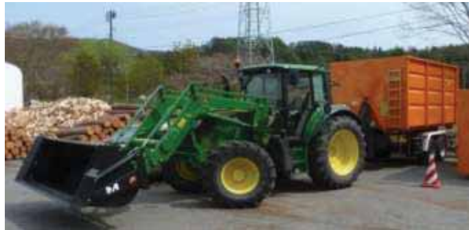
写真 2.2 アームロール式二重底牽引トレーラー
