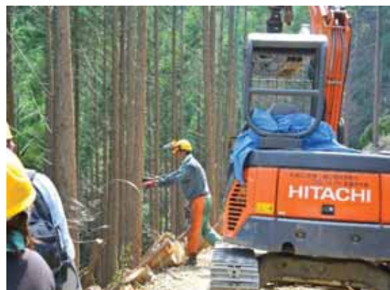
(b) グラップルオペレーターによるワイヤの投げ渡し
