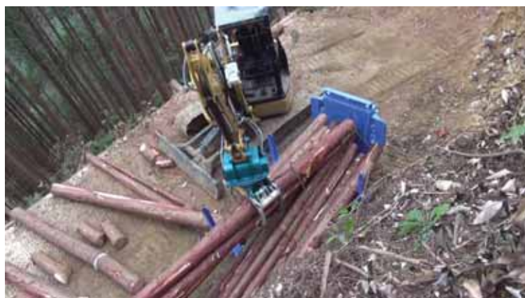
(b) 積込の様子（作業員 1 名が造材工程と並行して実施）
