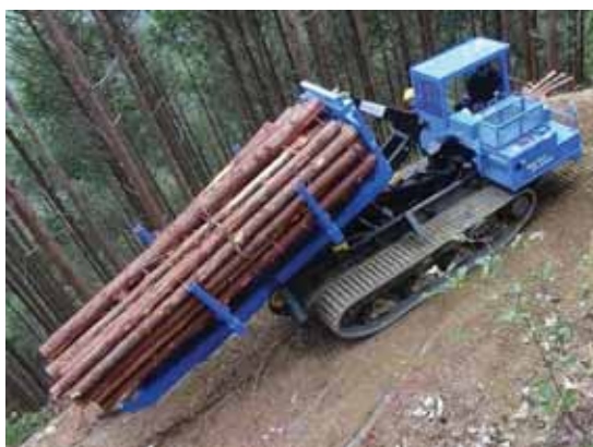
図 3-3 脱着フォワーダ（写真はコンテナ装着作業の様子）
