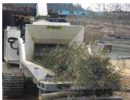
写真 5-68 バンドルの投入
