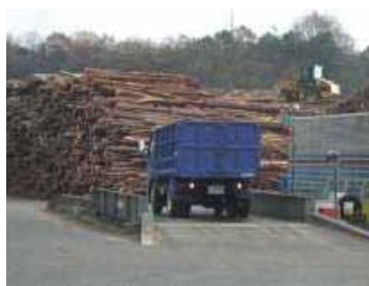
写真 5-70 トラックスケールによる計量
