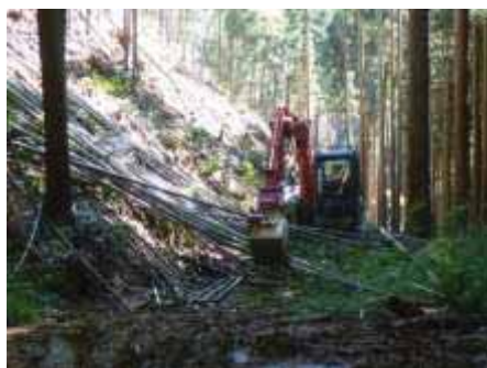
写真 5-1 フェラーバンチャによる集材
