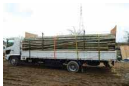
写真 5-55 荷締機+コンパネによる固定
