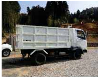
箱ダンプトラック
