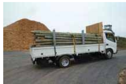
写真 5-60 荷締機による固定
