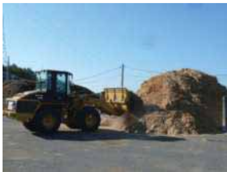
写真 5-29 一次破碎チップの積込
