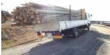
写真 5-54 荷締機だけの固定
