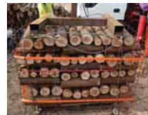
⑥吊り具を上に乗せ ワイヤーで固定
