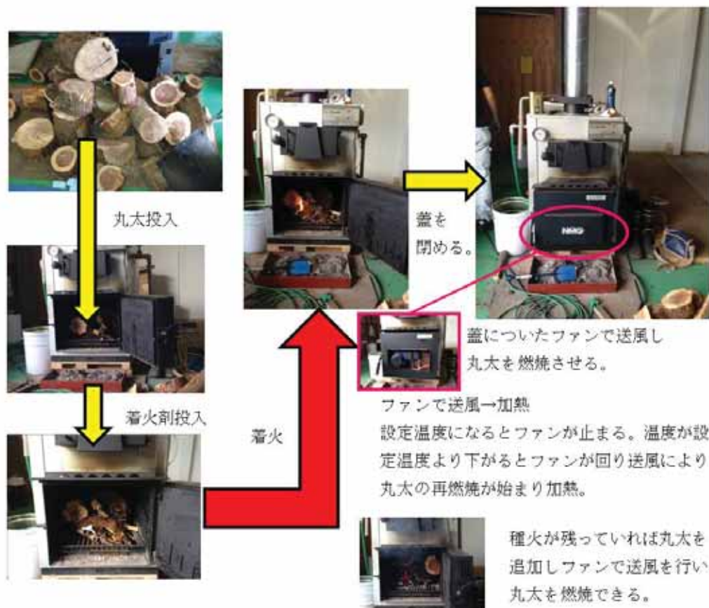
図一 61 木質バイオマス暖房機の運転開始方法
