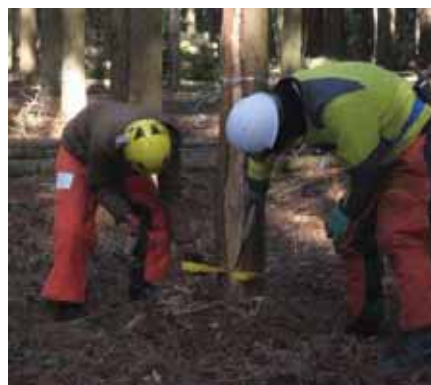
②倒したい方向の反対側から、必要に応じて複数使用
