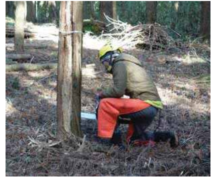
③最初に倒す方向から刃を入れる
