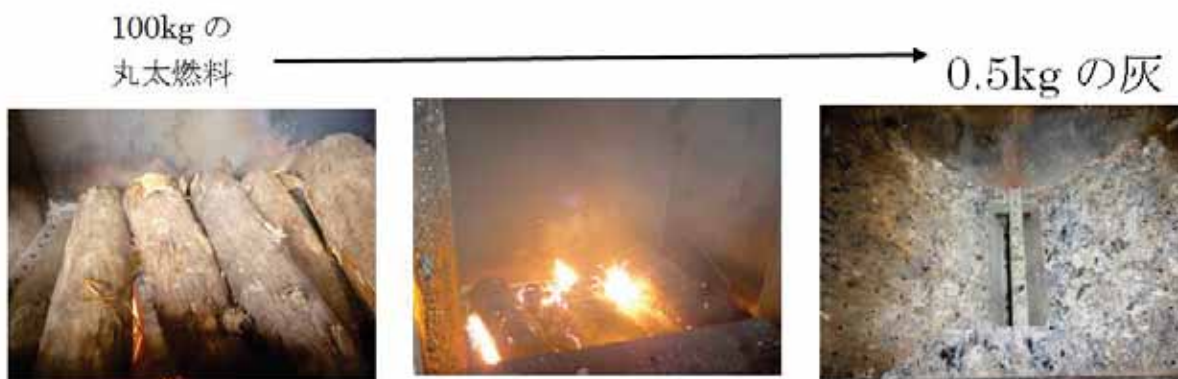
図ー 66 木質バイオマス暖房機炉内での丸太燃焼状況
