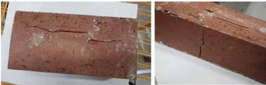
図 8-10 乾燥不十分な成形体の焼成結果
