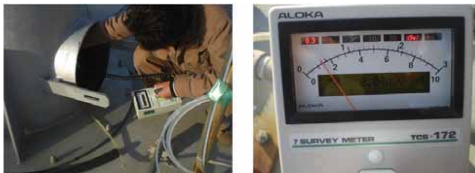
図 8-29 煙突下部における空間線量の測定
