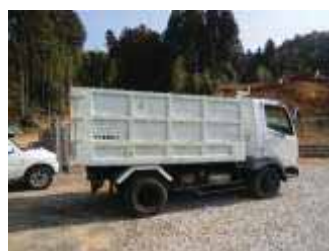
4t 箱ダンプトラック
