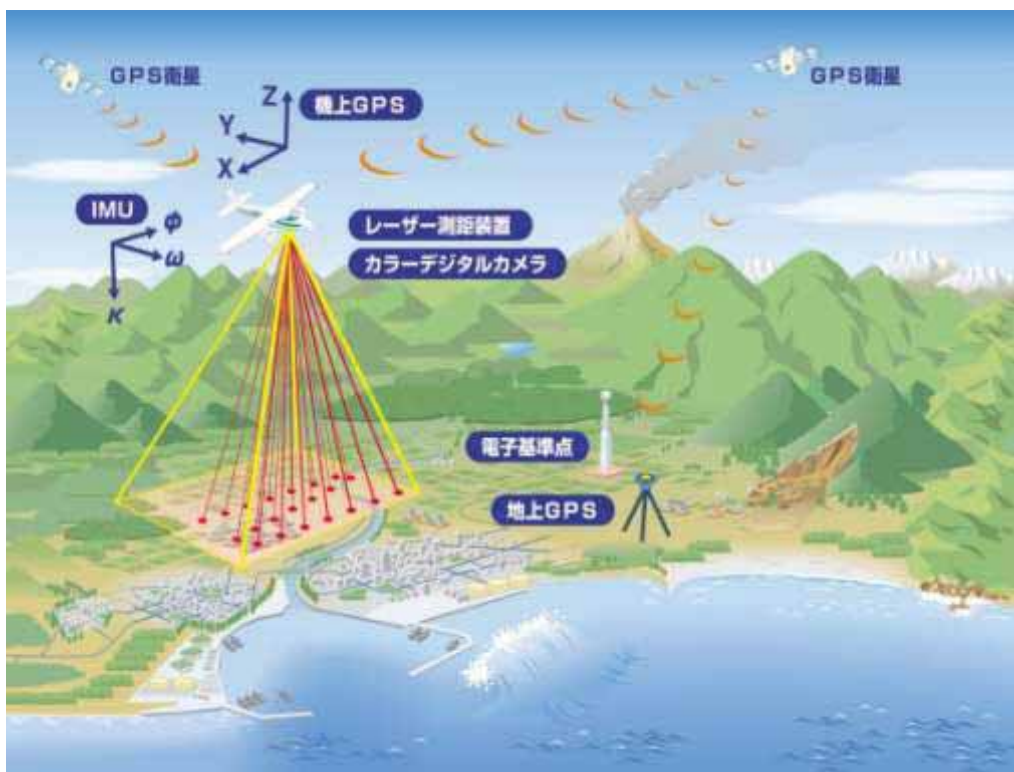
図5.3.2 航空レーザ測量概要
