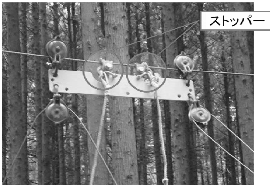
図表 30 改良しストッパーを取り付けた搬器
