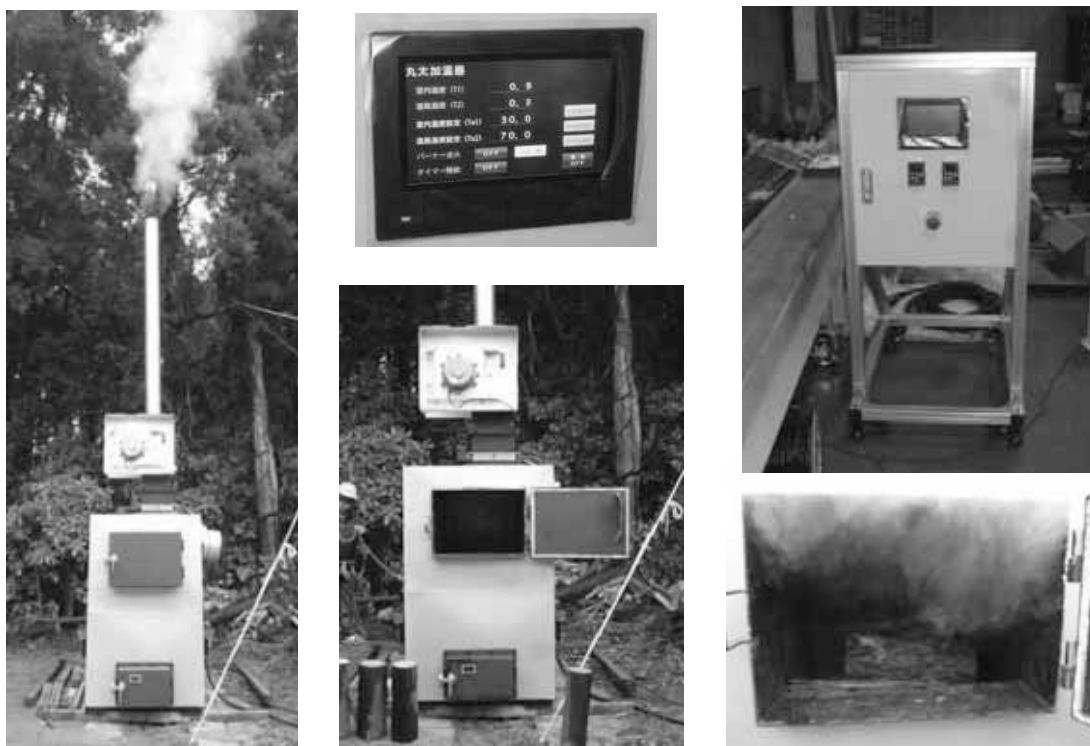
図表 267 新型温風式丸太加温器の試運転状況
