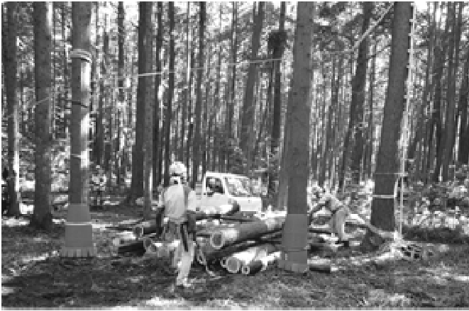
図表 28 軽トラウインチを使用した集材の様子
