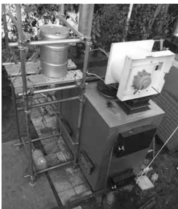
図表 276 バーナー用重油タンクの取り付け状態（全体）
