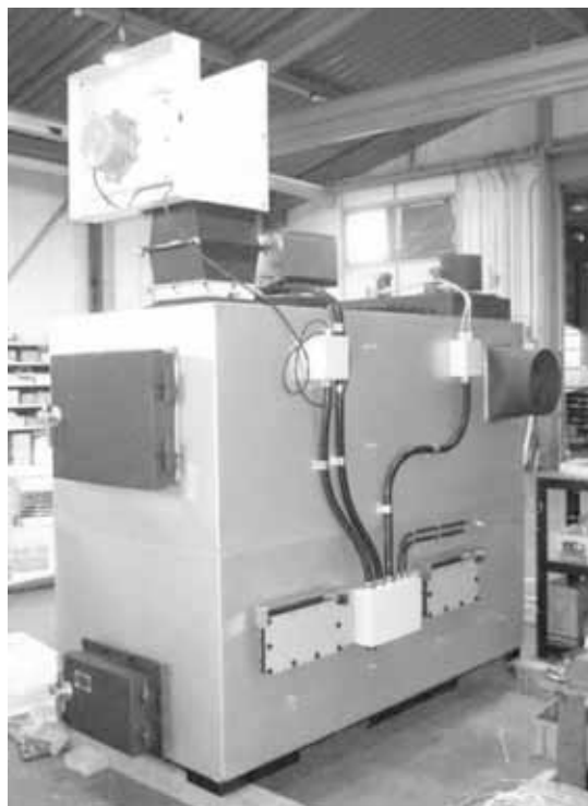
図表 261 燃焼室の容積を拡大した新型温風式丸太加熱器の外観
