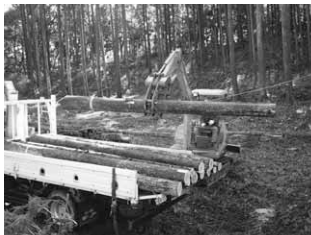
図表 8 Z フォークを用いた積み込みの様子
