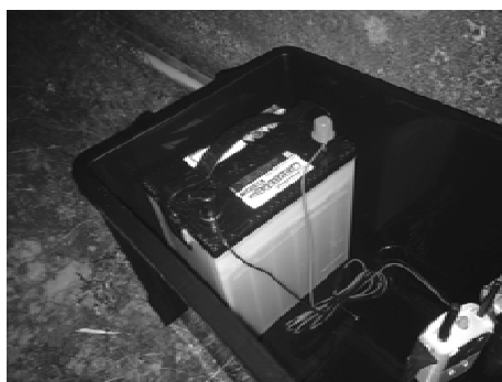
図表 283 監視・異常情報発信のための屋外発信機器のセット
