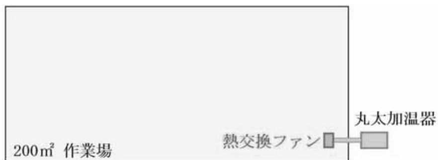
図表 146 丸太加温器設置状況
