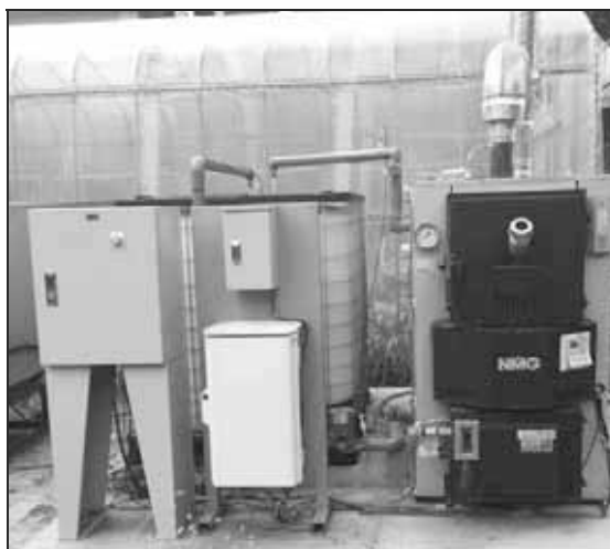
図表 248 燃焼実験装置(温水型丸太加温器)
