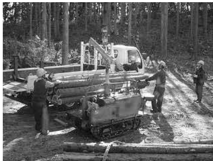
図表 13 スーパーやまびこからクレーンで積み込み
