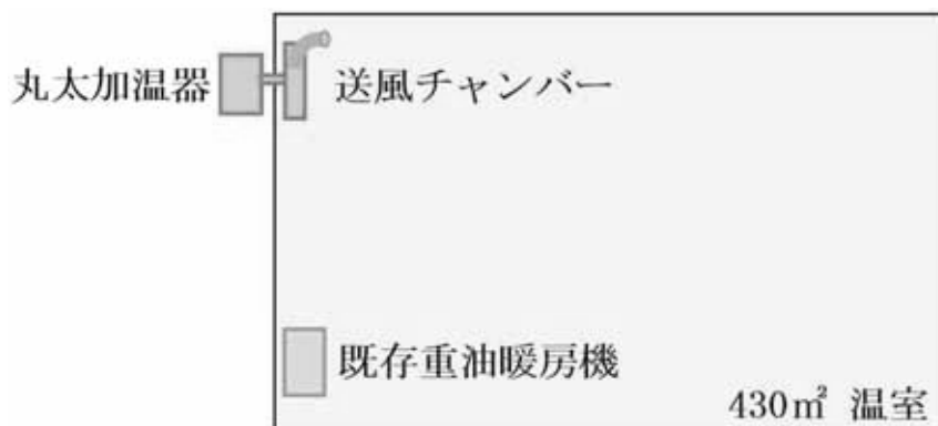
図表 62 1号機設置状況
