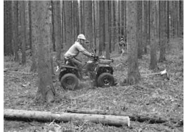
図表 29 ATV ウインチを使用した集材の様子
