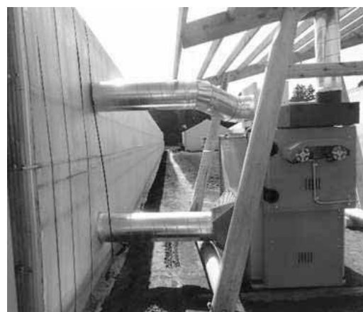
図表 79 丸太加温器内への配管
