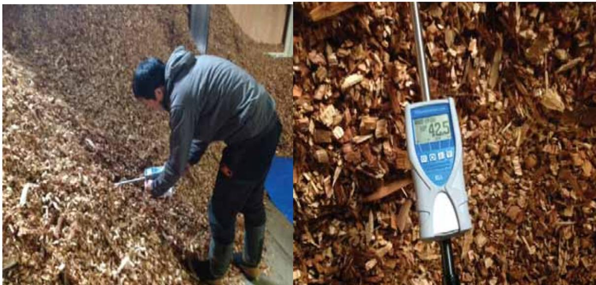
簡易型挿入式 含水率測定状況
