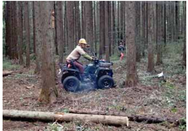
図 3-27 ATV ウインチを使用した集材の様子
