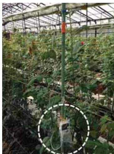
図 4-25 室内温度計の設置
