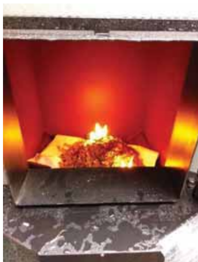
図 4-14 着火時の炉内の様子
