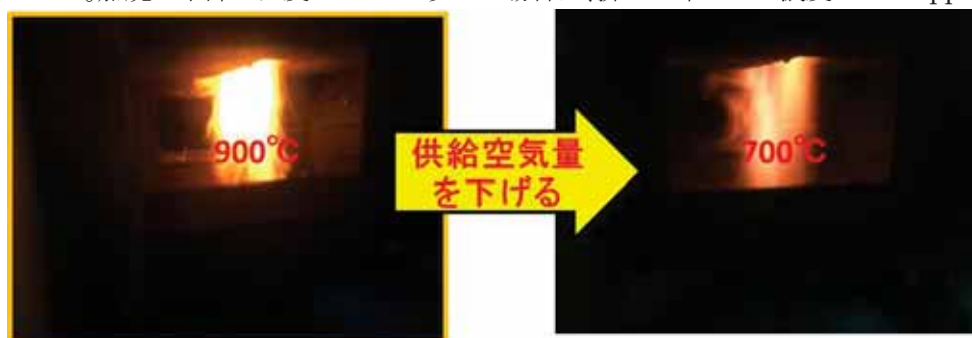
図 4-105 燃烧室下部からの炎の状態と温度
