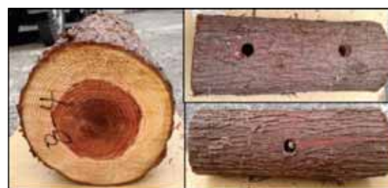
No. 8, 9: 穴 3ヶ所(3 Holes (S-V, L-V)) 直径 :12, 30 mm 、位置 : 垂直
