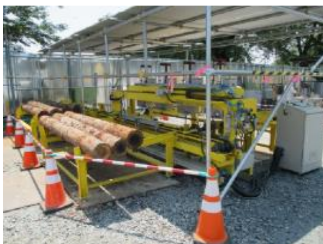
図 35. 改造後の木材表面自動測定機
