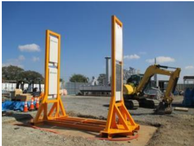
図 32. ゲート型測定機外観
