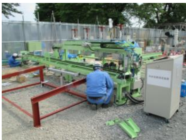
図 34. 木材表面自動測定機の改造状況
