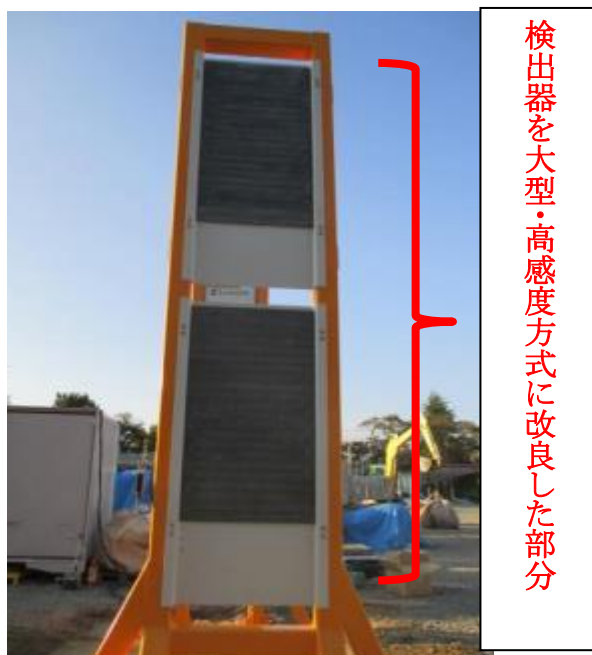
図 33. ゲート型測定機検出部
