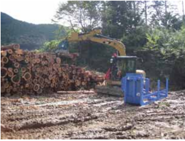
(a) 脱着フォワーダの荷台への積み込み作業
