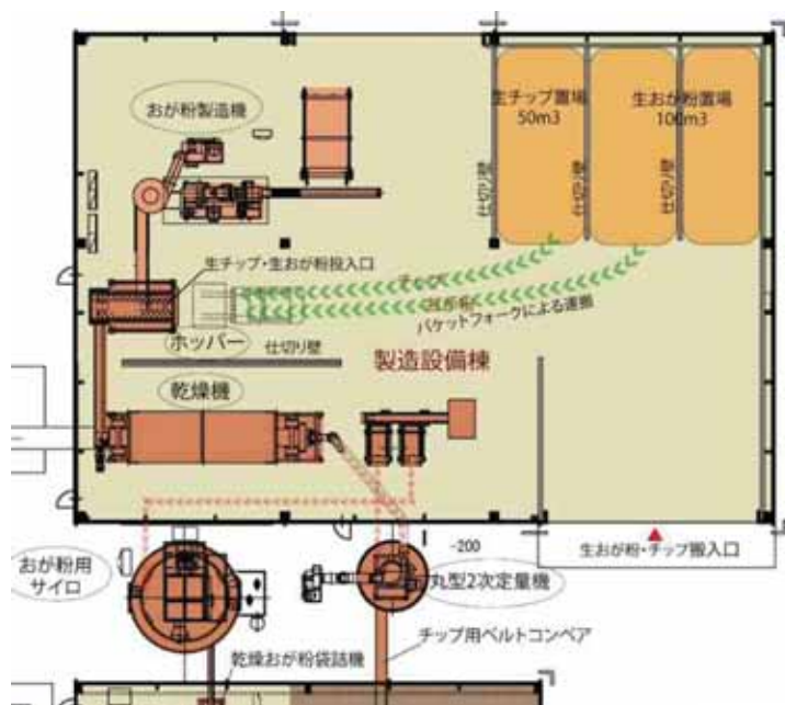
図-4 ホッパーへの生チップ・おが粉の投入
