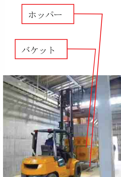
写真-4 ホッパーへの生チップ・おが粉の投入
