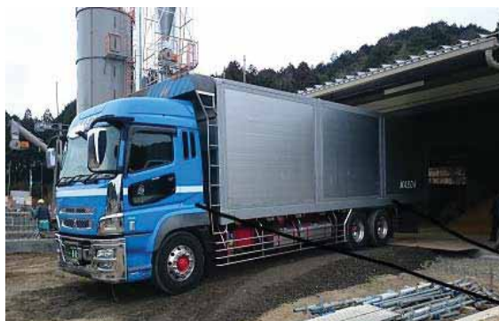
55 m 3 のスライドデッキ付コンテナにより入荷。
