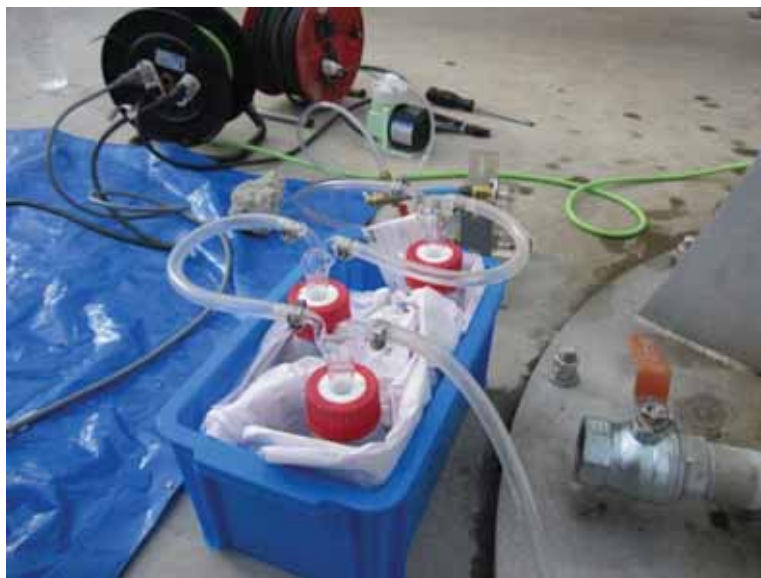
図 9-6 ばいじん吸引後の燃焼ガス後処理装置
