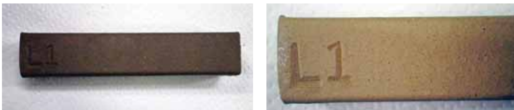
図 9-26 郡山配合原土の成形体(乾燥前及び乾燥後)
