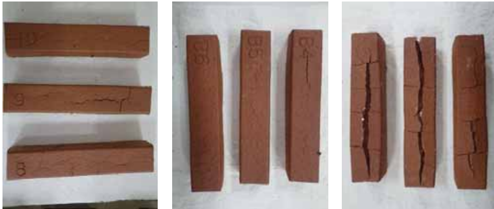
図 9-17 配合②の焼成体 (左) 並びに配合③の焼成体表 (中) 及び裏 (右)
