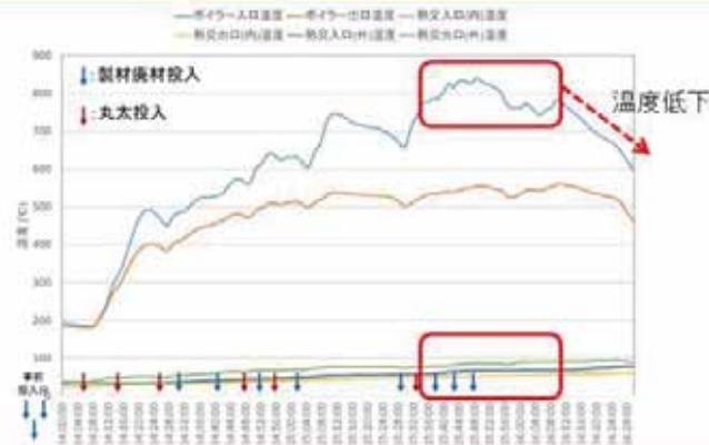
ボイラー出入口及び温水の温度変化(試行2:ボイラー1基稼働・パーク未利用)
