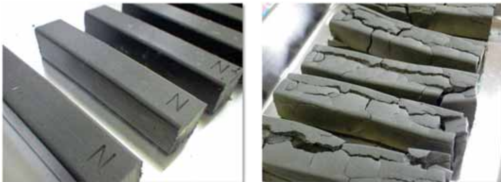
図 9-12 北上粘土配合成形体（乾燥前及び乾燥後）
