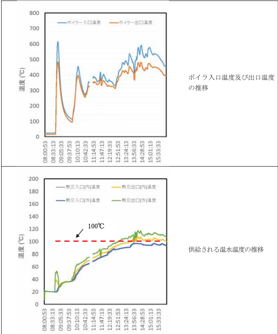
図 7-1 ボイラー出入口及び温水の温度変化 (試行 1)
