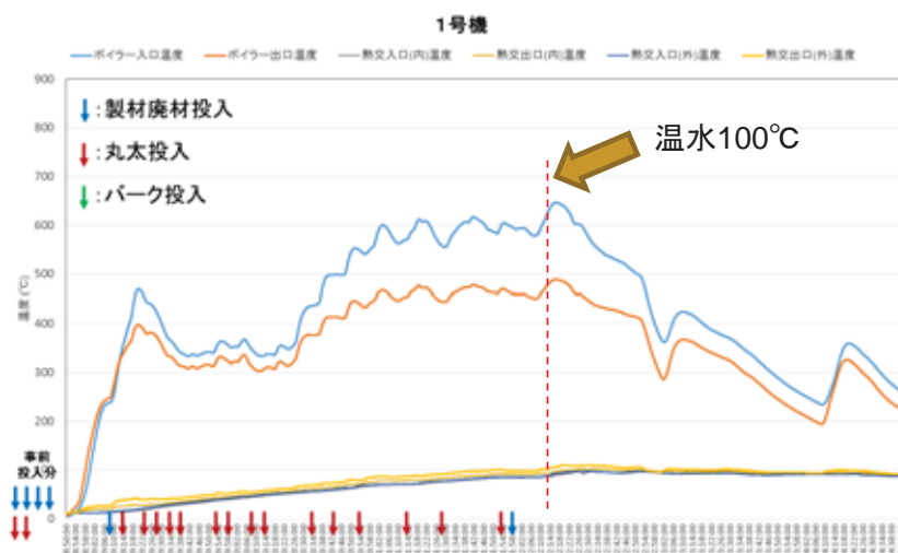
図 7-7 ボイラ出入口及び温水の温度変化（試行 5・1 号機）
