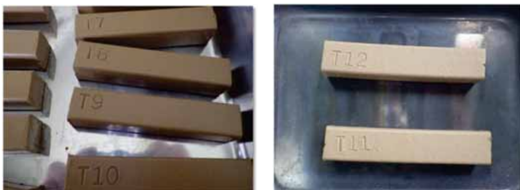
図 9-14 遠野粘土成形体（乾燥前及び乾燥後）
