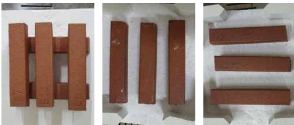
図 9-18 配合③の焼成体表 (左) 及び裏 (中) 並びに配合④の焼成体表 (右)
