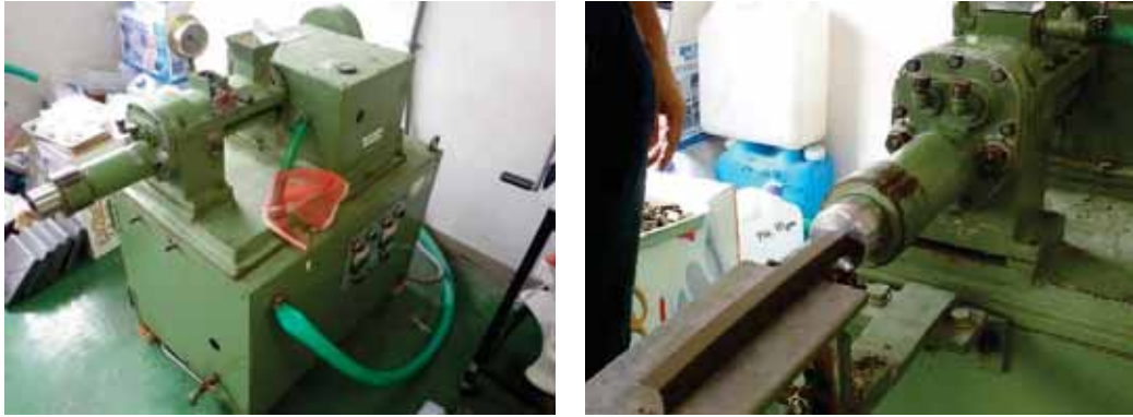
図 9-10 真空土練機（左）及び成形試験の様子（右）
