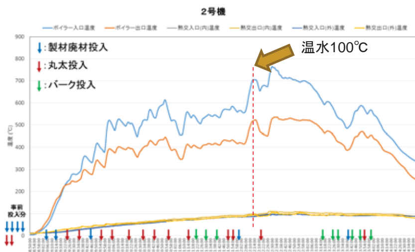
図 7-8 ボイラ出入口及び温水の温度変化（試行 5・2 号機）
