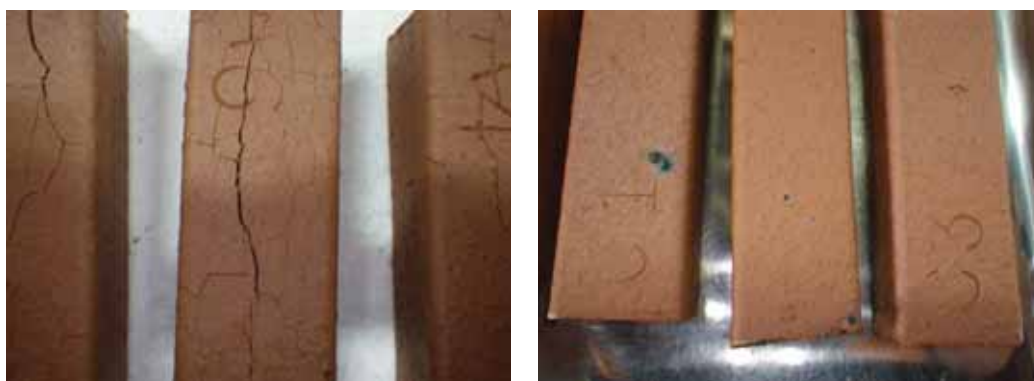
図 9-19 配合②の焼成体（左）及び配合④の焼成体（右）
