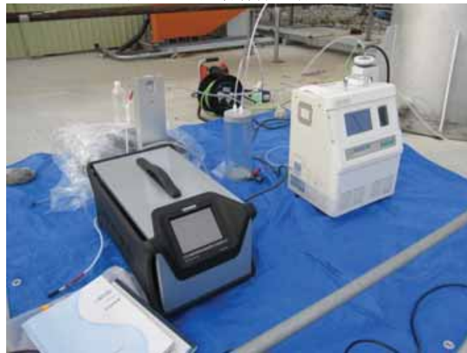
図 9-3 燃焼ガス分析装置
