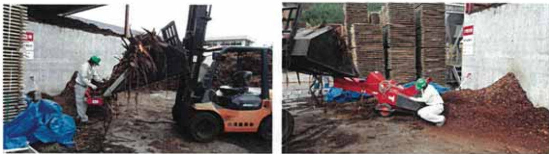
図表 6-3 破砕機 A による破砕の様子（左/投入の様子、右/詰まりを取り除く作業）
