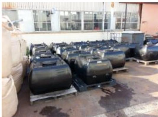
図 11. 木酢液・タールの貯蔵タンク
