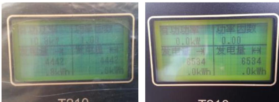
図 14. 発電量の記録 (左・運転開始後、右・運転終了前)
