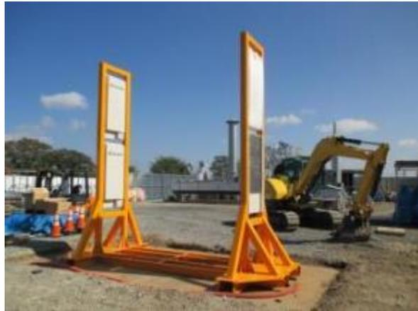
図 3. ゲート型測定機
