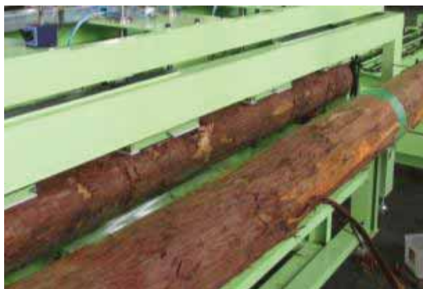
図 57. 木材が測定部から押し出され、次の木材が測定部に送られている状況
