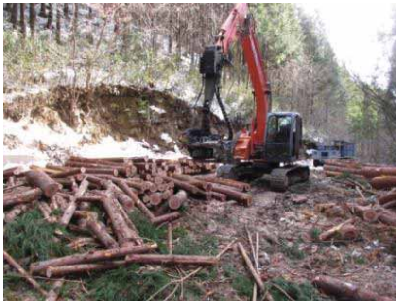
図 7. プロセッサ付バックホウ：木材を一定の長さに切断する機能が付いたグラップル
