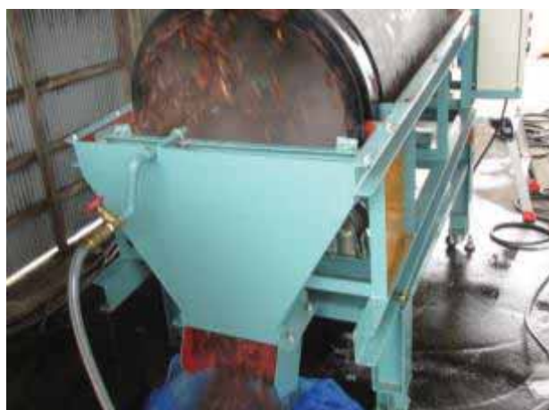
図 77. ドラム型洗浄機の洗浄の状況
