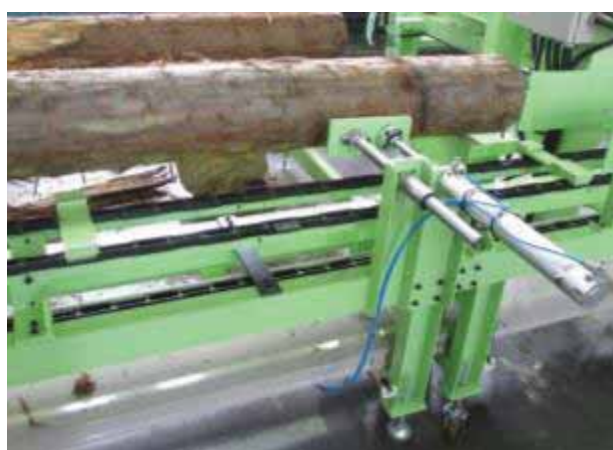
図 59. 木材が搬出部に送られている状況
