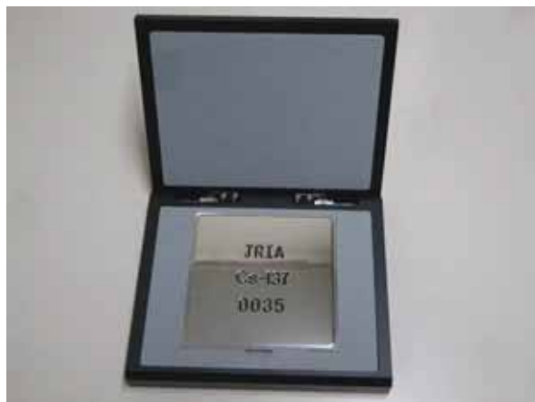
図 49. 精度確認に使用した標準線源と校正の様子
