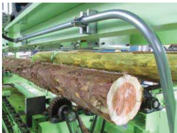
図 56. 測定部が上昇・移動している状況
