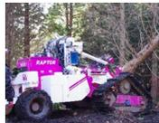
伐倒の遠隔操作化
