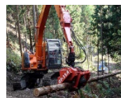
＜材の枝払い、玉切り等を連続して行う高性能林業機械＞
