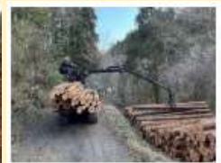
フォワーダによる丸太の運搬後、帰り荷でコンテナ苗を運搬
