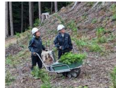
小型運搬車 (電動クローラ型1輪車)
