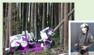
遠隔操作伐倒機械
