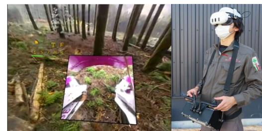
遠隔操作式伐倒機械による伐倒の様子（上）
