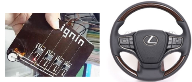
改質リグニンを使用した製品開発の例 電子基板（左）とステアリング（右）
