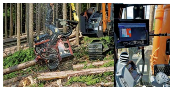
バリューバッキング機能付きハーベスタ（細りの予測から生産価格が高まる径級や長さなどを機械が提案）
