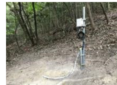
崩壊発生予測の実証 (山地の土壌水分量・水温の観測)
