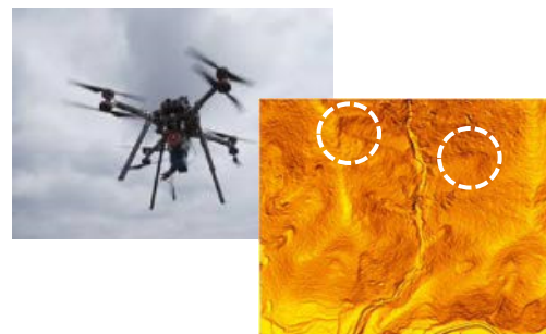
ドローンレーザによる崩壊危険箇所の特定
