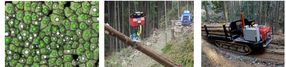
レーザ計測による森林調査      自動で集材する架線集材機      自動走行するフォワーダ
