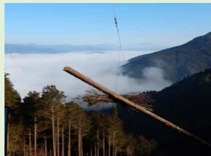
架線による素材と枝条の搬出
