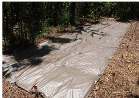
外来種であるギンネムの遮光シートによる発芽抑制試験の様子
