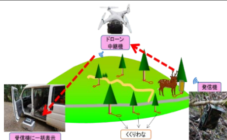
無人航空機を活用したわな捕獲通知システムの概要図
