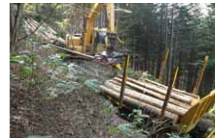
プロセッサによる造材作業と フォワーダによる搬出作業
