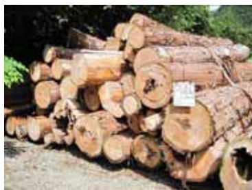
屋根葺き替え用資材の天然サワラ
