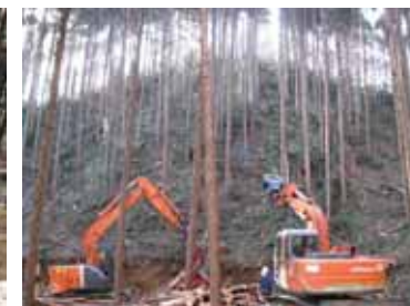
スイングヤードによる集材と プロセッサによる造材作業
