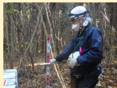
空間線量率測定 ふたば なみえまち (福島県双葉郡浪江町：令和7(2025)年11月)
