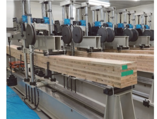
基準強度が定められていないスギ CLT(9層9プライ)の強度試験 (写真提供：国立研究開発法人森林研 究・整備機構森林総合研究所)
