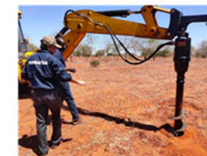
重機を使った植穴の掘削 (写真提供：JIFPRO)
