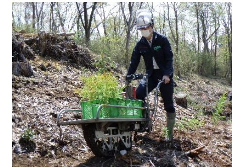
斜面での苗木運搬等を軽労化できる電動クローラ型一輪車
