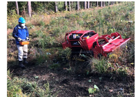
遠隔操作により下刈り作業を軽労化できる下刈り機械
