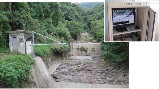
左：監視カメラと土石流センサーの設置
