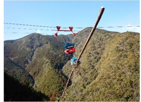
遠隔操作が可能な架線式グラップルと油圧集材機による「新たな架線式集材システム」を開発
