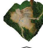
レーザーキヤナを 用了3次元起工測量
