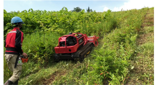
小型遠隔操縦式下刈り機
