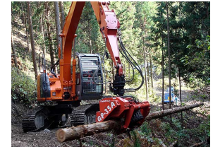
材の枝払い、玉切り等を連続して行う高性能林業機械
