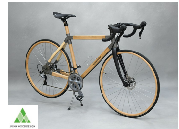
ウッドデザイン賞2022 林野庁長官賞 フレームにヒノキを用いた自転車
