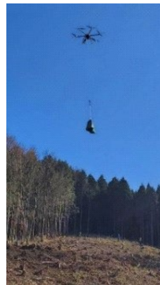
ドローンによる苗木の運搬
