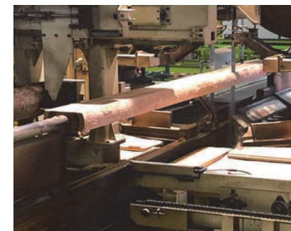
高原工場における平角生産の様子
