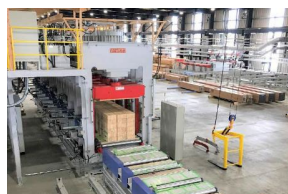
集成材製造設備
