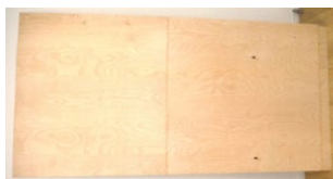
フロア台板のシラカバ合板
