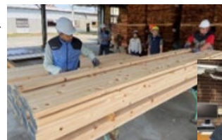
パシフィック木材検査機関(PLIB)による試験材の等級判定
