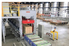
集成材製造設備
