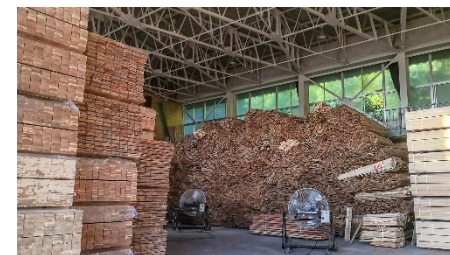
旧中学校体育館を活用した乾燥室
