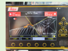
ICT法面掘削機 ガイダンス画面
