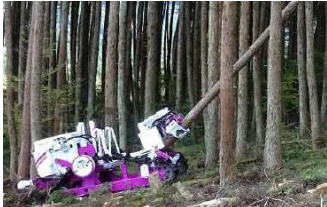
遠隔操作・自動運転伐倒機械
