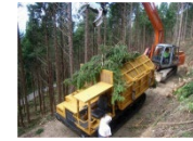
残材の搬出に適したフォワーダ
