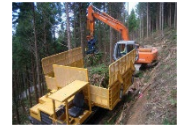
残材の搬出に適したフォワーダ
