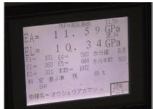
รูป 4-2 บันทึกค่าคำนวณ โมดูลัสยืดหยุ่น (ค่า Young's Modulus) ของลามิनाเข้าสู่คอมพิวเตอร์
