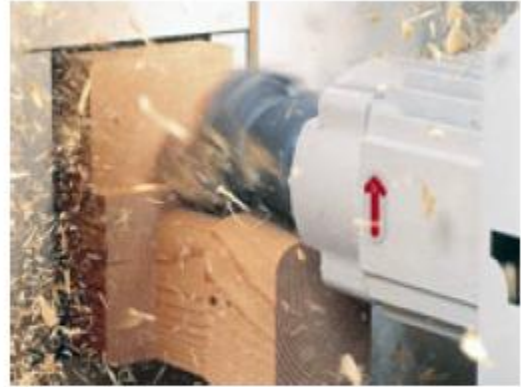
รูป 3-21 การแปรรูปตัดเตรียมสำเร็จ (Pre-cut) ของชิ้นงานไม้
