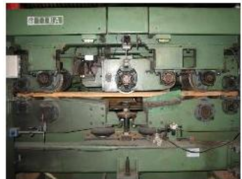
รูป 4-3 ภายในเครื่องเกรดดิ่งแบบต่อเนื่อง
