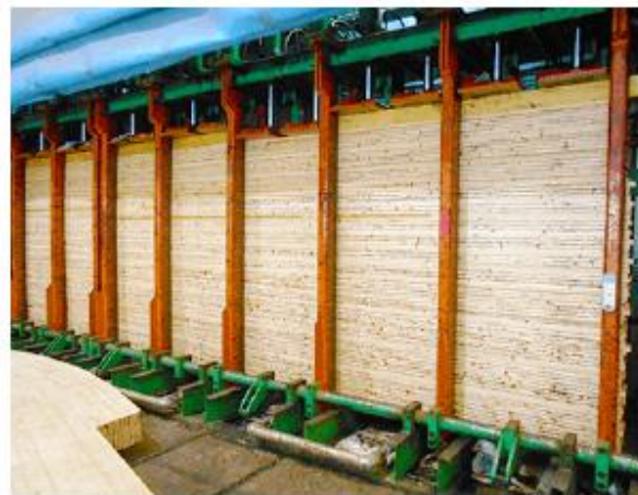
รูป 4-9 เครื่องอัดขนาดใหญ่สำหรับหน้าตัดใหญ่
