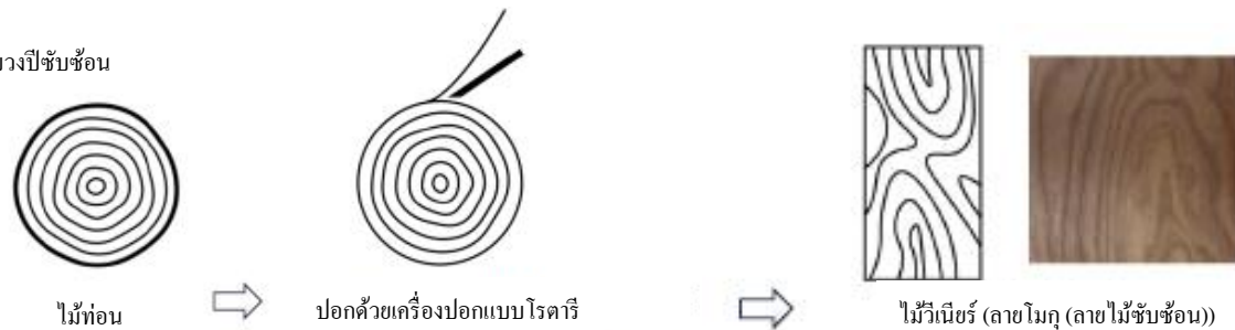
รูปที่ 3-14 วิธีการปอกไม้วีเนียร์และชนิดลายไม้ที่ได้
