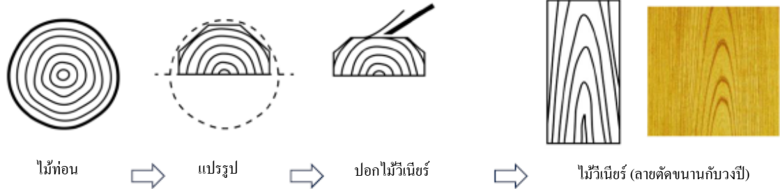
“การปอกแบบตัดขนานกับวงปี”
