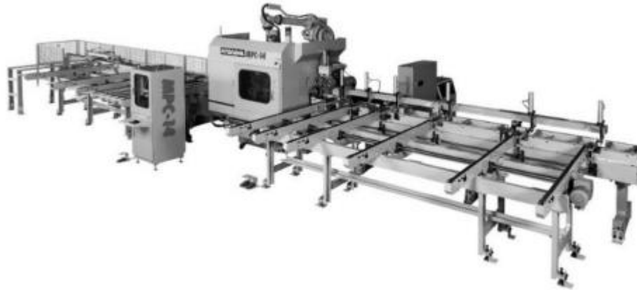
รูป 4-19 สายการแปรรูปวัสดุทองโครงสร้าง
