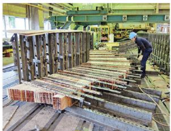
Gambar 4-10 Pengepresan bahan berpenampang besar yang melengkung dengan tangan
