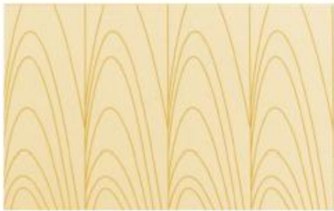
Slip match (Direkatkan secara berdampingan dengan arah yang sama)
