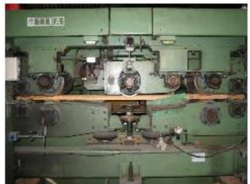
Gambar 4-3 Bagian dalam mesin grading tipe kontinu
