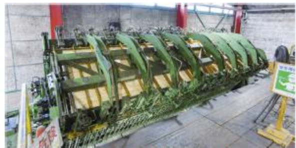
Gambar 4-8 Pengepresan dingin tipe putar untuk penampang kecil
