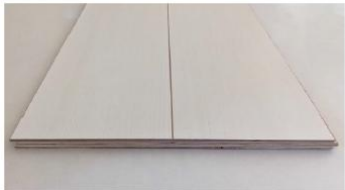
Gambar 2-24 Lantai komposit berbahan dasar kayu lapis dari pohon konifera
