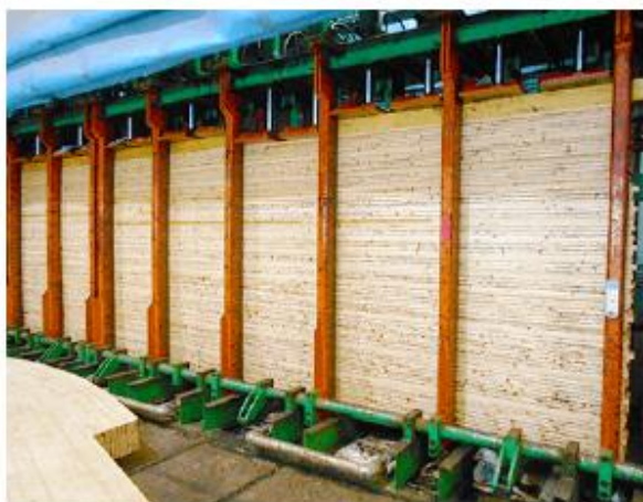
Gambar 4-9 Mesin pengepresan berukuran besar untuk penampang besar
